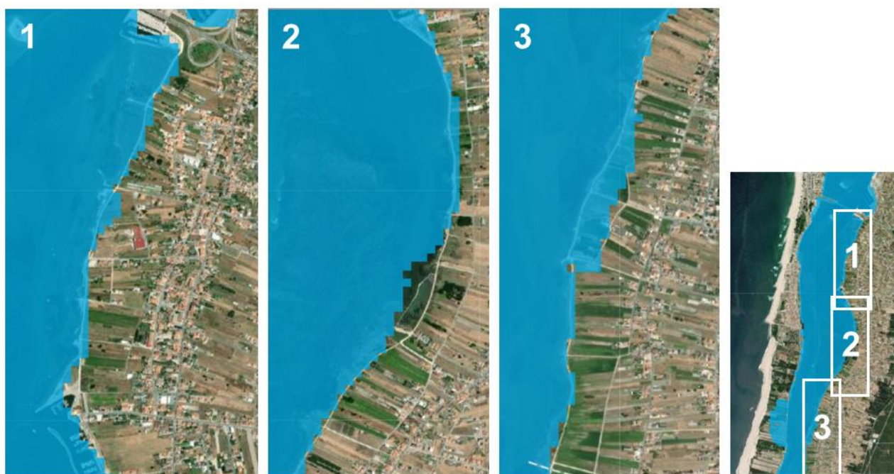
Figura 3. Área de inundação com um período de retorno de 1000 anos, segundo a Cartografia de Áreas Inundáveis de Riscos de Inundações (2.º Ciclo), na área abrangida pelas UOPG 04, 06 e 07
