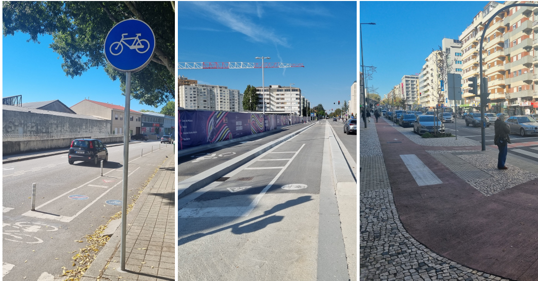
Fig. 19 Exemplos de segregação física do canal ciclável
