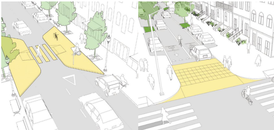
Fig. 59 Exemplos de soluções a implementar em Zonas 30 para o aumento da segurança nos atravessamentos Fonte: NACTO, 2016
