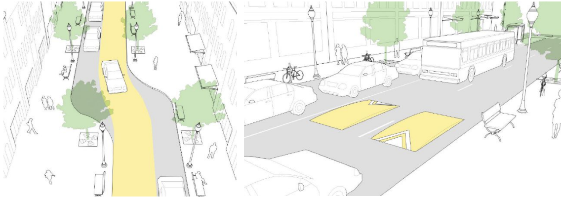
Fig. 60 Exemplos de soluções a implementar em Zonas 30 para a redução da velocidade Fonte: NACTO, 2016
