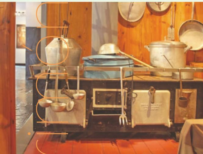
“[...] Junto à antepara da ré, fica o fogão, peça fulcral no funcionamento da cozinha, como é evidente. Grande fogão, de fabrico Paula Dias, funciona a carvão de pedra; posteriormente, foi evoluindo, sofrendo uma adaptação para gasóleo por volta dos anos 50, combustível muito prático e limpo. Com fornalha a meio, um forno de cada lado para o pão e tanque para aquecimento de água doce, ainda suporta sob o seu tampo, com
